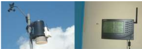
Fig.1 a) Estación meteorológica ubicada en la facultad de ingeniería Civil; b) Consola que almacena los datos de la estación enviados inalámbricamente por la estación.
