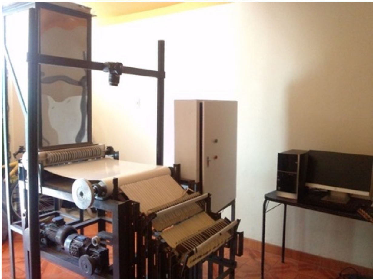
Figura 6. Máquina clasificadora de quinua por color ensamblada.
